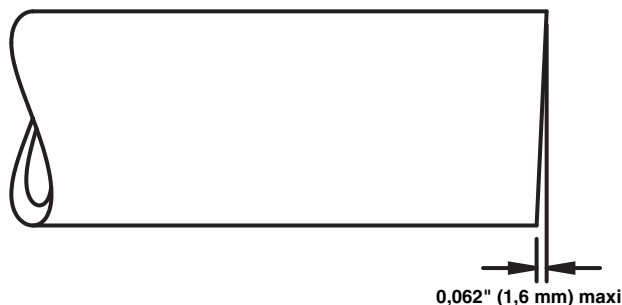
Figure 5 – Faux équerre maximal du tuyau
