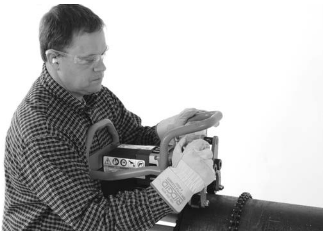
Figure 17A – Serrer la vis de blocage manuellement
