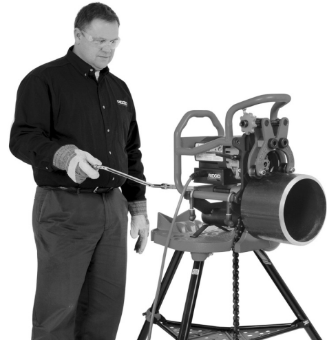
Figure 20C – Biseautage en cours (machine fixe/tuyau mobile)
