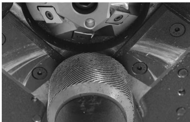
Figura 22 – Superficie moleteada del rodillo de mando, limpia
