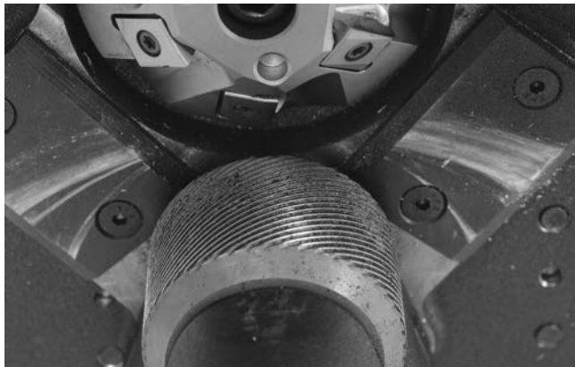
Figure 22 – Nettoyage du moletage du galet d'entraînement
