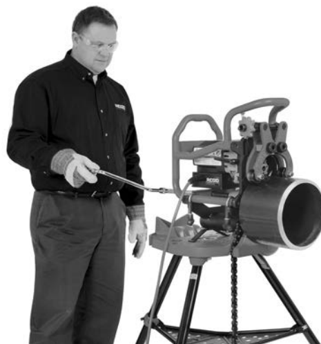
Figura 20C – Operación de biselado (biseladora fija/tubo en rotación)
