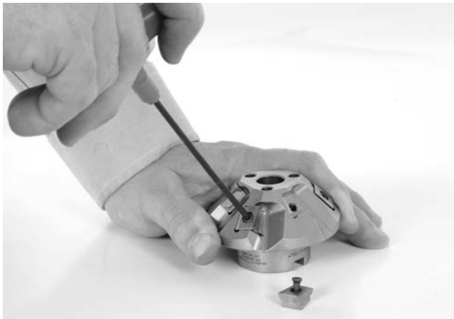
Figure 24 – Remplacement des couteaux
