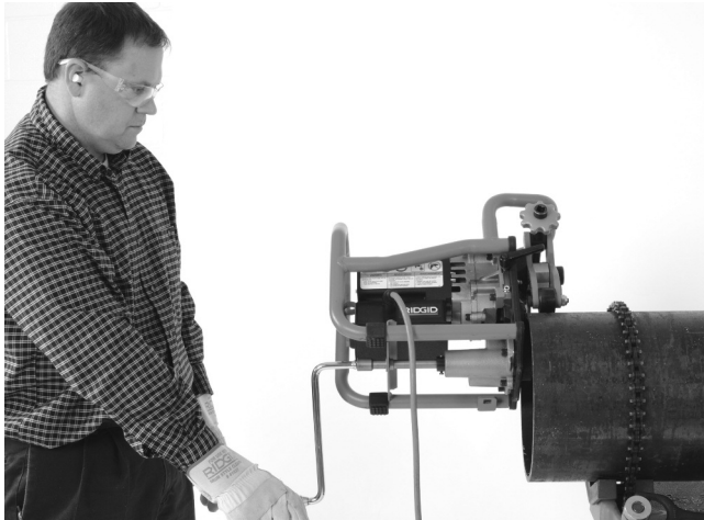
Figure 20A – Biseautage en cours (pièce fixe/machine mobile)
