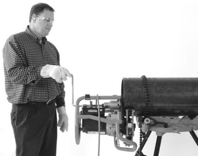
Figura 20B – Operación de biselado (pieza fija/biseladora móvil)
